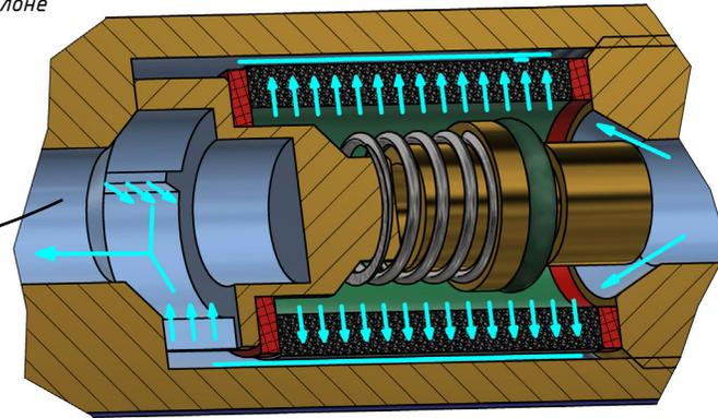
Работа клапана при обратном ударе
