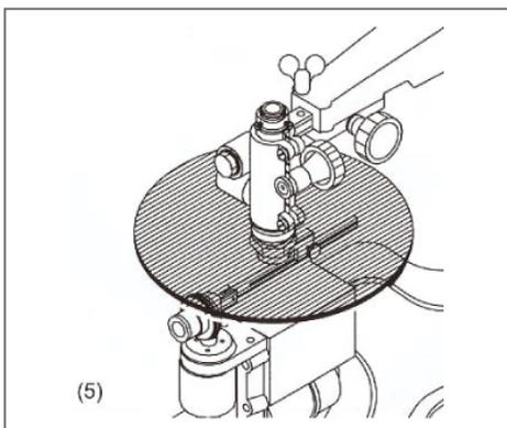
Отсоедините гайку (1) и отсоедините детали (2) и (3).
