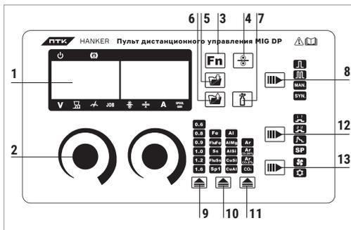
1. Цифровые дисплеи отображения сварочных параметров и настроек
