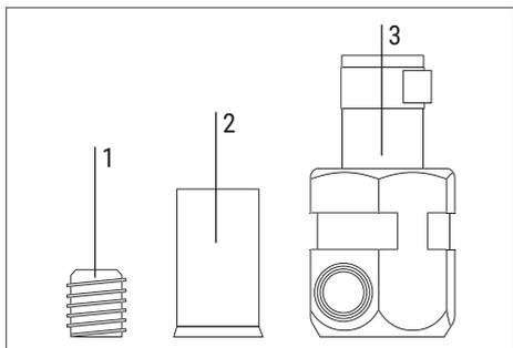
1. Винт крепления сварочного кабеля
