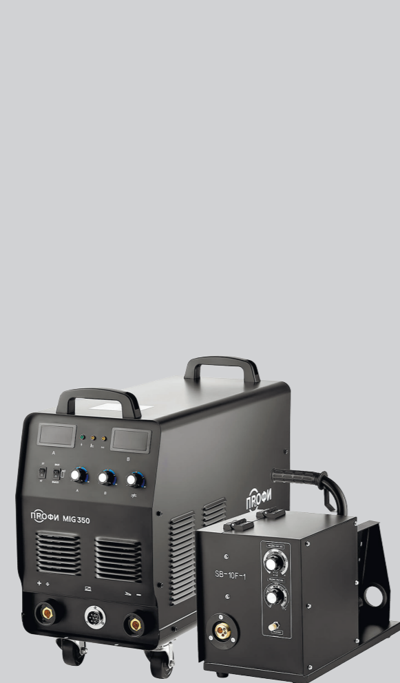
ПРОФИ MIG 350 Артикул 005.200.206 Напряжение питающей сети, В 380±15% Сварочный ток MIG, А 50–350 Диаметр проволоки, мм 1,0–1,2 ПВ на максимальном токе, % 60
