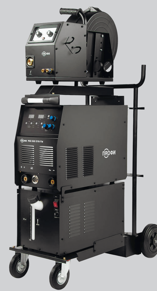
ПРОФИ MIG 500 SYN FW Артикул 005.200.212 Напряжение питающей сети, В 380±15% Сварочный ток MIG, А 20–500 Диаметр проволоки, мм 0,8–1,6 ПВ на максимальном токе, % 60
