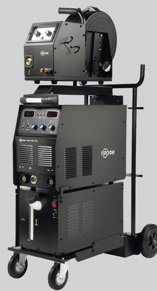
ПРОФИ MIG 500 FW Артикул 005.200.211 Напряжение питающей сети, В 380±15% Сварочный ток MIG, А 50–500 Диаметр проволоки, мм 1,0–1,6 ПВ на максимальном токе, % 60
