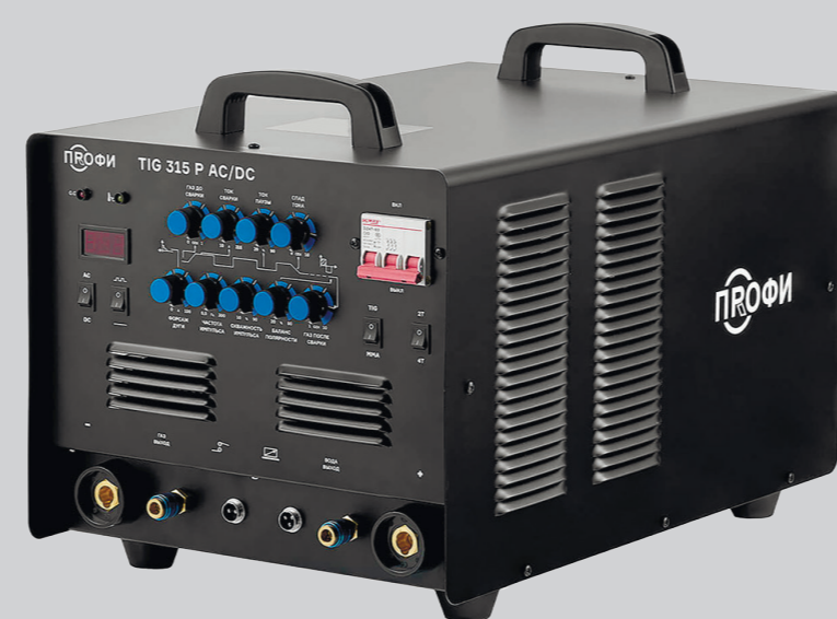
ПРОФИ TIG 315 P AC/DC Артикул 005.200.403 Напряжение питающей сети, В 380±15% Сварочный ток TIG, А 10–315 Тип тока AC/DC Диаметр электрода, мм 1,0–4,0 ПВ на максимальном токе, % 60
