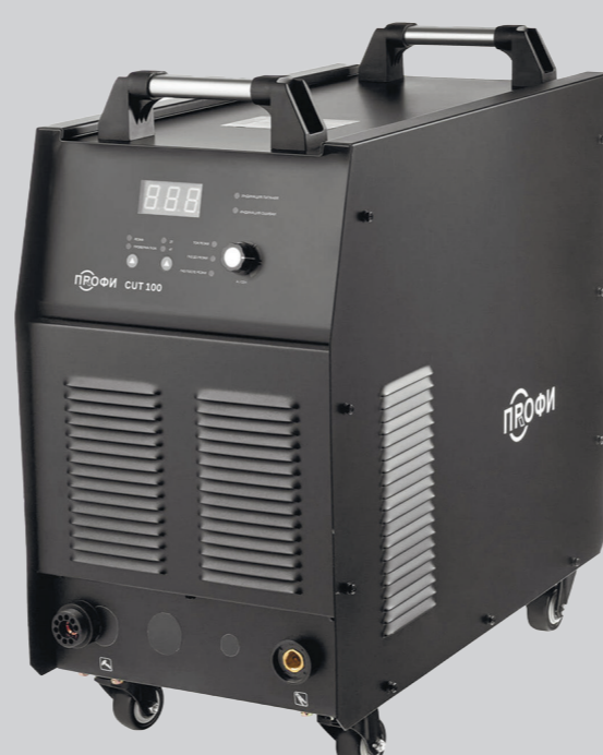
ПРОФИ CUT 100 Артикул 005.200.505 Напряжение питающей сети, В 380±15% Ток реза CUT, А 20–100 Максимальная толщина реза, мм 35 ПВ на максимальном токе, % 60
