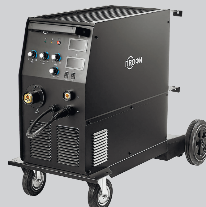
ПРОФИ MIG 350-1 Артикул 005.200.208 Напряжение питающей сети, В 380±15% Сварочный ток MIG, А 50–350 Диаметр проволоки, мм 0,8–1,2 ПВ на максимальном токе, % 60
