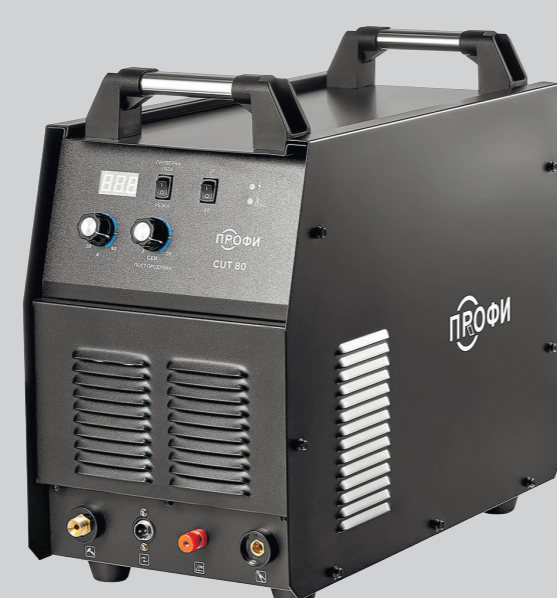
ПРОФИ CUT 80 Артикул 005.200.504 Напряжение питающей сети, В 380±15% Ток реза CUT, А 20–80 Максимальная толщина реза, мм 30 ПВ на максимальном токе, % 60
