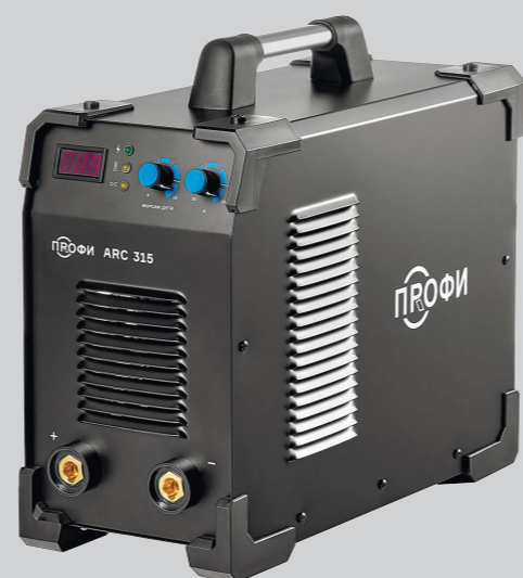
ПРОФИ ARC 315 Артикул 005.200.104 Напряжение питающей сети, В 380±15% Сварочный ток ММА, А 20–315 Диаметр электрода, мм 1,5–6,0 ПВ на максимальном токе, % 60
