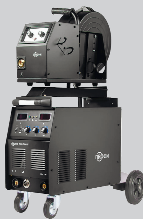
ПРОФИ MIG 500 F Артикул 005.200.210 Напряжение питающей сети, В 380±15% Сварочный ток MIG, А 50–500 Диаметр проволоки, мм 1,0–1,6 ПВ на максимальном токе, % 60
