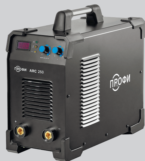
ПРОФИ ARC 250 (380V) Артикул 005.200.106 Напряжение питающей сети, В 380±15% Сварочный ток ММА, А 20–250 Диаметр электрода, мм 1,5–5,0 ПВ на максимальном токе, % 60
