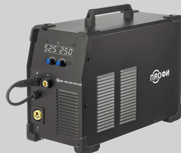
ПРОФИ MIG 250 SYN LED Артикул 005.200.209 Напряжение питающей сети, В 380±15% Сварочный ток MIG, А 40–250 Диаметр проволоки, мм 0,6–1,0 ПВ на максимальном токе, % 60
