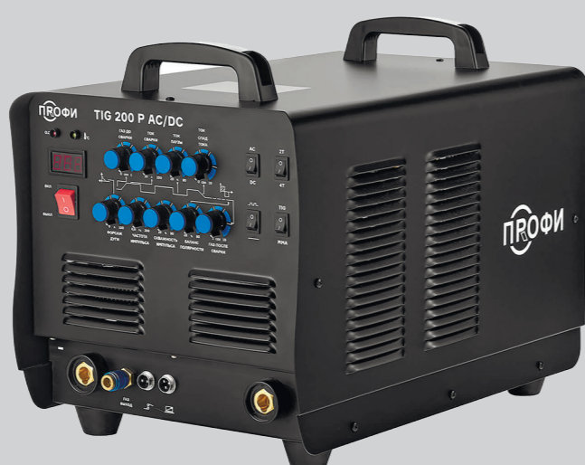
ПРОФИ TIG 200 P AC/DC Артикул 005.200.401 Напряжение питающей сети, В 220±15% Сварочный ток TIG, А 10–200 Тип тока AC/DC Диаметр электрода, мм 1,0–3,2 ПВ на максимальном токе, % 60
