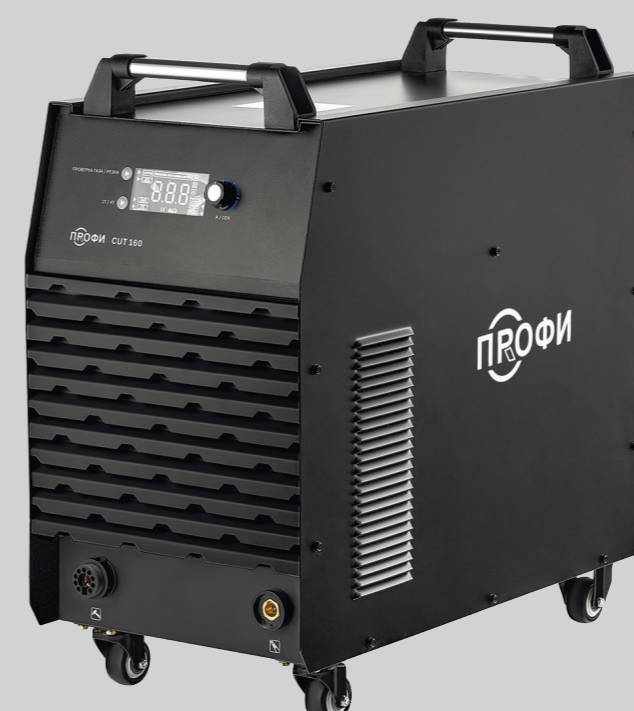
ПРОФИ CUT 160 Артикул 005.200.502 Напряжение питающей сети, В 380±15% Ток реза CUT, А 20–160 Максимальная толщина реза, мм 55 ПВ на максимальном токе, % 60
