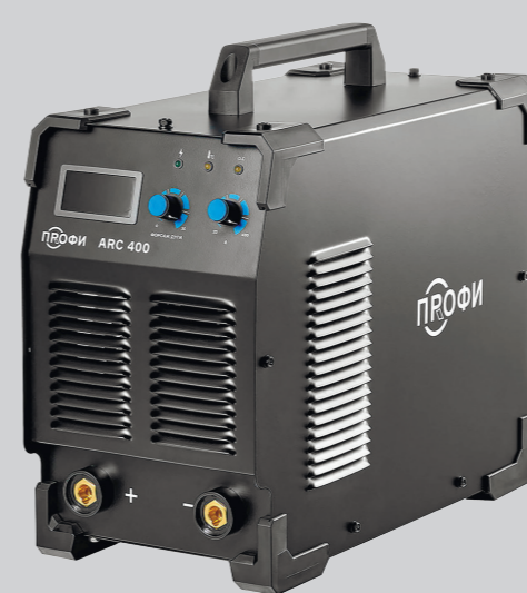
ПРОФИ ARC 400 Артикул 005.200.108 Напряжение питающей сети, В 380±15% Сварочный ток ММА, А 20–400 Диаметр электрода, мм 1,5–6,0 ПВ на максимальном токе, % 60
