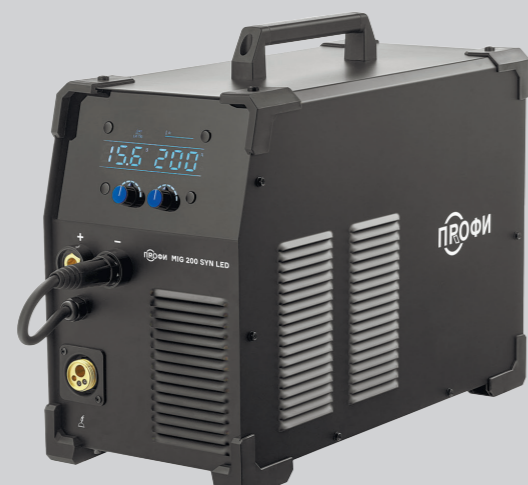
ПРОФИ MIG 200 SYN LED Артикул 005.200.201 Напряжение питающей сети, В 220±15% Сварочный ток MIG, А 30–200 Диаметр проволоки, мм 0,6–1,0 ПВ на максимальном токе, % 60
