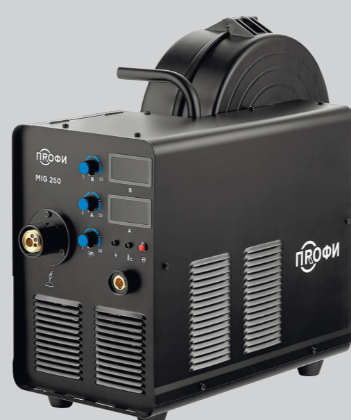
ПРОФИ MIG 250 Артикул 005.200.203 Напряжение питающей сети, В 380±15% Сварочный ток MIG, А 50–250 Диаметр проволоки, мм 0,6–1,0 ПВ на максимальном токе, % 60
