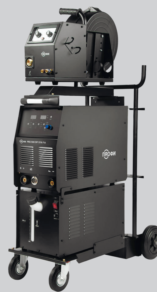
ПРОФИ MIG 500 DP SYN FW Артикул 005.200.213 Напряжение питающей сети, В 380±15% Сварочный ток MIG, А 20–500 Диаметр проволоки, мм 0,8–1,6 ПВ на максимальном токе, % 60
